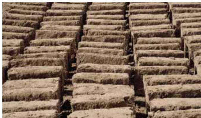
Séchage de briques de terre avant leur mise en œuvre. Vallée du Dadès (Maroc).
